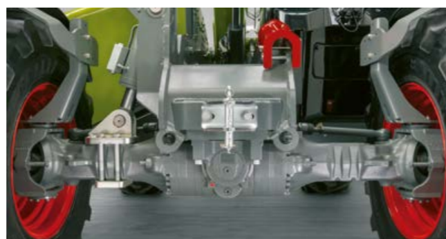
Podvozek s hydraulickým vyrovnáváním vodorovné polohy.
