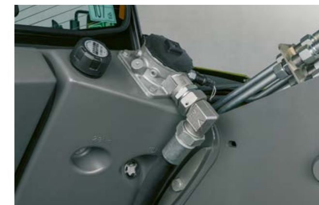
Stav hydraulického oleje je možné kontrolovat přes průzor. Hydraulický systém je chráněn zpětným filtrem. Filtr měňte až po 1 000 provozních hodinách.
