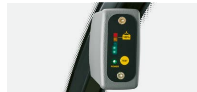
Zobrazení zatížení s jednoznačnou světelnou symbolikou: Je-li překročena hranice stability, rozsvítí se všechny diody a zazní tón alarmu.
