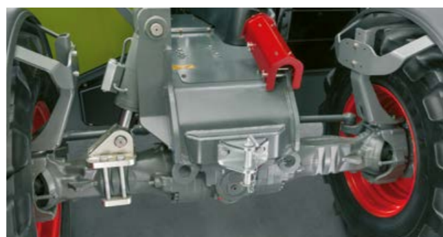
Větší bezpečnost v terénu díky funkci hydraulického vyrovnávání
