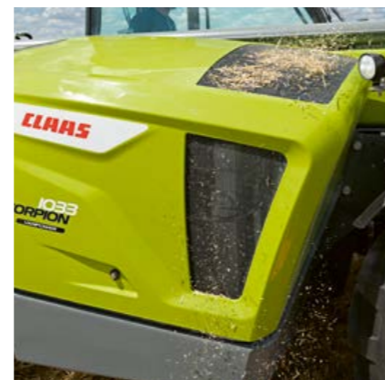
Zabránění znečištění chladiče díky reverznímu ventilátoru
