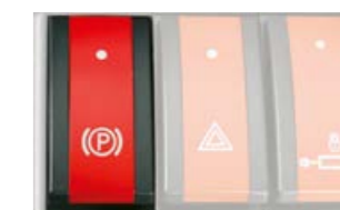
Parkovací brzda může být kolébkovým spínačem aktivována manuálně.
