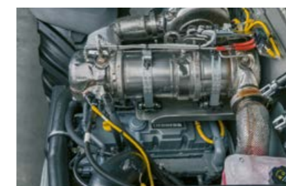
Filtr pevných částic se automaticky regeneruje.
