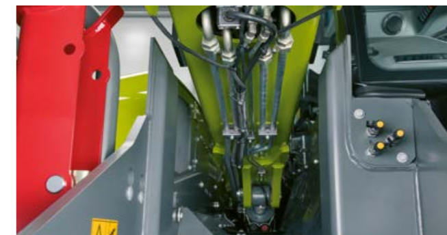
Boční vedení teleskopického ramene je sériově integrováno v rámu pro všechny nakladače s nosností nad 4500 kg
