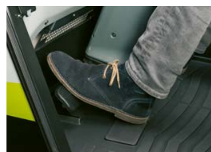
Brzdový pedál s Inch funkcí redukuje spotřebu pohonných hmot a opotřebení brzd.
