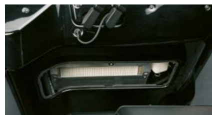
Dobrý přístup ke vzduchovému filtru kabiny
